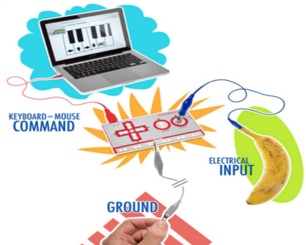
Figura 3 - Infográfico explicando como o Makey Makey se comporta.
