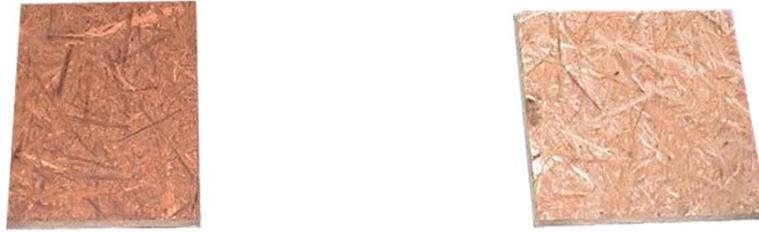
Figura 36. Painel de bambu com partículas orientadas - OSB. (Fonte: <http://www.greencorp.com>, 2006).
