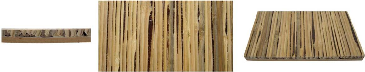
Figura 38. Painel de MDF revestido com ripas de bambu e pó de coco colado (Fotos: SALIM MOIZÉS).
