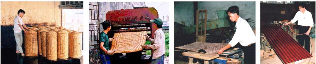
Figura 33. Processo de fabricação do painel ondulado (Fonte: <http://www.bamboocomposites.com>).
