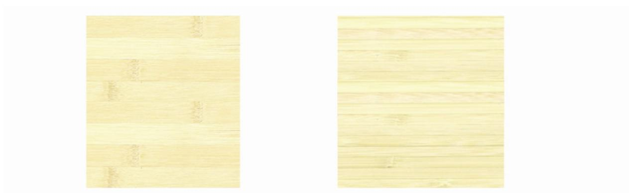
Figura 15- Lâminas de bambu descoradas, alvejadas (*Bleaching*).
