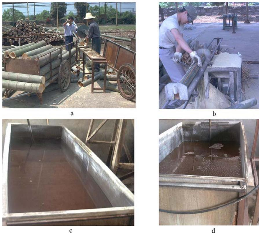
Figura 09. a) Cortes transversais do colmo; b) Cortes longitudinais de um colmo; c) e d) tanques para imersão no tratamento de imunização (Fotos: MARCO PEREIRA, China, 2000).
