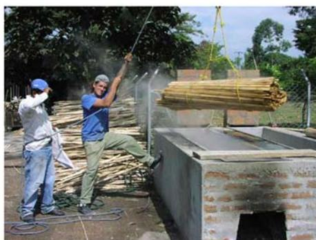
Figura 14- Processo de descolorir (*Bleaching*) tiras de bambu (Fonte: <http://www.ecobamboo.net>).
