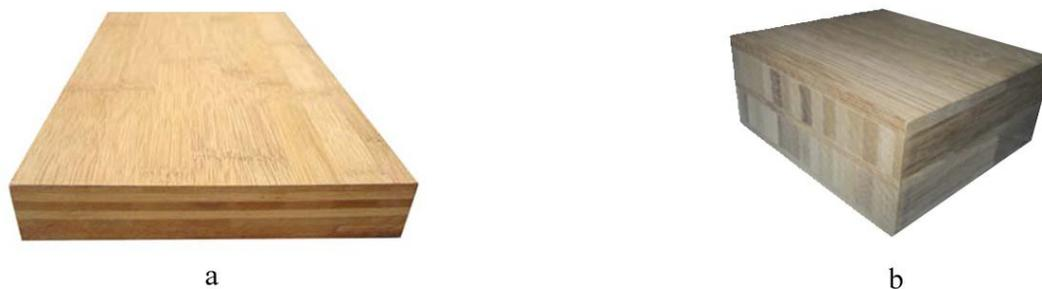
Figura 24. a) Painel contra-placado carbonizado (Fonte: <http://www.tigerbamboo.com>); b) Painel contra-placado natural (Fonte: <http://www.dingobamboo.com>).
