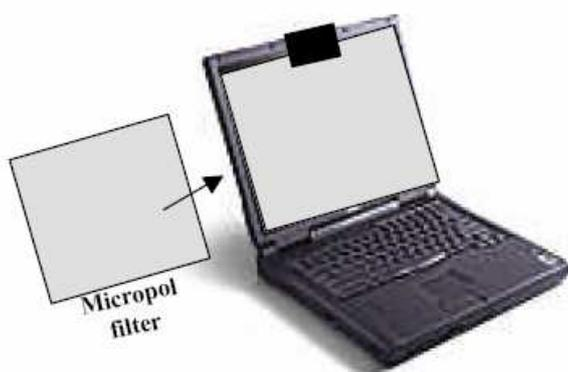
**Ilustração 135:** Filtro Micropol para aplicação em telas de notebook. Fonte: [http://www.vrex.com/products/\\_\\_download/vrex\\_mp\\_kit.pdf](http://www.vrex.com/products/__download/vrex_mp_kit.pdf)
