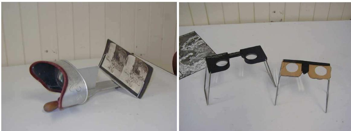
**Ilustração 117:** Estereoscópio de Holmes. Fonte: [http://geodesia.ufsc.br/Geodesia-online/arquivo/cobrac\\_2002/006/Souza7.jpg](http://geodesia.ufsc.br/Geodesia-online/arquivo/cobrac_2002/006/Souza7.jpg)
