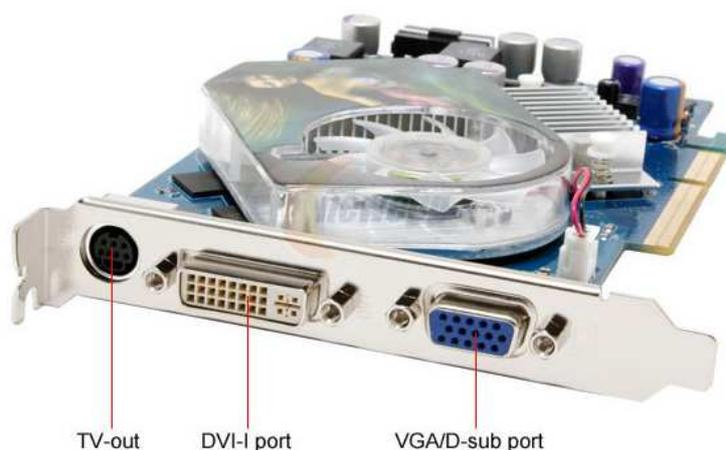
**Ilustração 159:** Placa de vídeo dual com uma saída DVI, uma saída VGA e uma de TV. Fonte:
