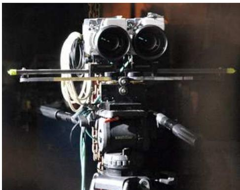
**Ilustração 67:** Duas Filmadoras adaptadas para filmagem estereoscópica, sem dispositivo de gravação. Fonte: [http://www.inition.co.uk/inition/product.php?URL\\_=product\\_stereovis\\_inition\\_3dvidrig&SubCatID\\_=4](http://www.inition.co.uk/inition/product.php?URL_=product_stereovis_inition_3dvidrig&SubCatID_=4)
