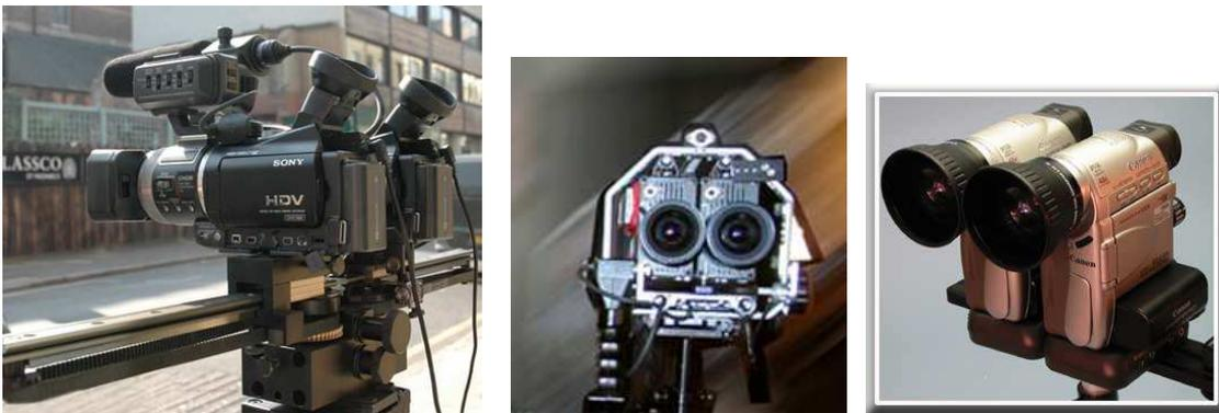
**Ilustração 64:** Duas Filmadoras adaptadas para filmagem estereoscópica. Fonte: [http://www.inition.co.uk/inition/product.php?URL\\_=product\\_stereovis\\_inition\\_3dvidrig&SubCatID\\_=4](http://www.inition.co.uk/inition/product.php?URL_=product_stereovis_inition_3dvidrig&SubCatID_=4)
