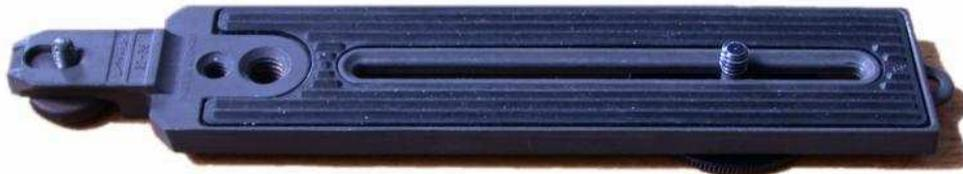
**Ilustração 75:** Adaptador de tripé com a função de auxiliar na obtenção de fotos estereoscópicas com apenas uma câmera. Nele, é possível realizar a primeira imagem e deslizar a câmera no trilho para realizar a outra foto, mantendo as duas imagens paralelas. Fonte: <http://www.stanford.edu/dept/SUSE/projects/ireport/articles/3D/3D%20VR%20types.pdf>
