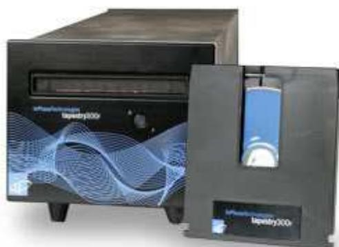
**Ilustração 16:** Disco de armazenamento de dados holográfico. Fonte: <http://www.inphase-technologies.com/products/default.asp?tnn=3>
