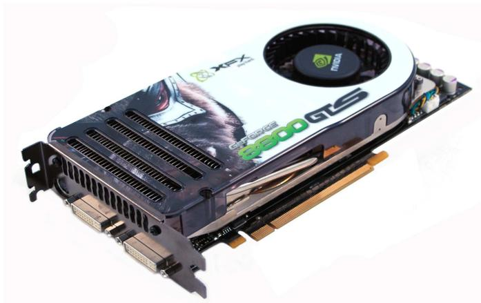
**Ilustração 160:** Placa de vídeo dual com duas saídas DVI, e saída de TV (HDTV, S-Video, Composite). Fonte: [http://produto.mercadolivre.com.br/MLB-65324672-placa-de-video-xfx-geforce-8800-gts-640mb-320bits-dx10-1ano\\_JM](http://produto.mercadolivre.com.br/MLB-65324672-placa-de-video-xfx-geforce-8800-gts-640mb-320bits-dx10-1ano_JM)
