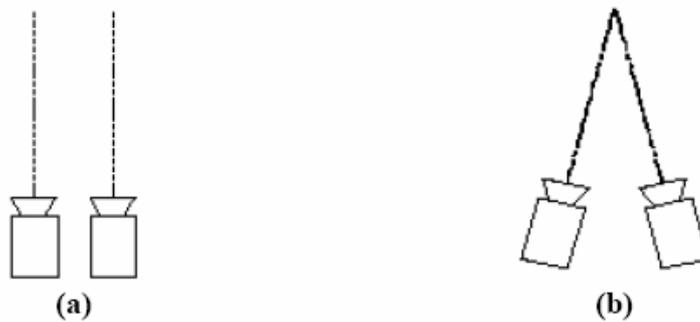
**Ilustração 40:** Duas câmeras posicionadas em eixo paralelo. Fonte: [http://www.tecgraf.puc-rio.br/~abraposo/pubs/livro\\_pre\\_svr2004/CAP11\\_stereo.pdf](http://www.tecgraf.puc-rio.br/~abraposo/pubs/livro_pre_svr2004/CAP11_stereo.pdf)
