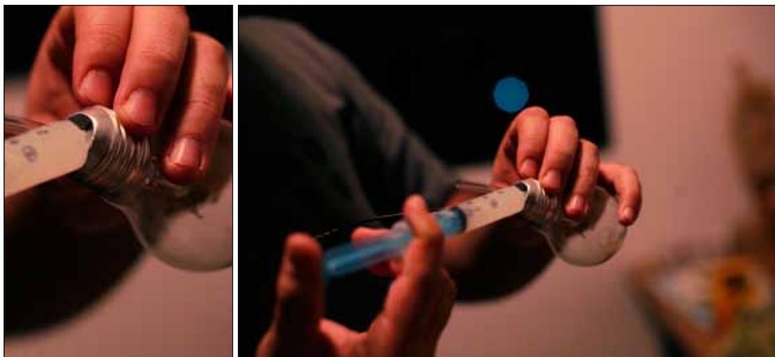
Por fim, acabei encontrando uma mangueira com diâmetro diferente, que encaixou perfeitamente e o problema estava solucionado. Nesse momento uma saída de escape seria necessária, então surgiu a ideia de furar as lâmpadas. Utilizei brocas diamantadas e uma retífica.
