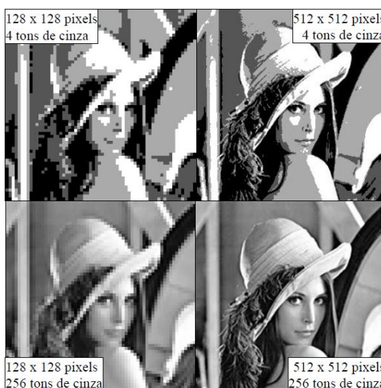
Figura 12 - Resolução e profundidade. Fonte: Adaptado de Gomes (2001)
