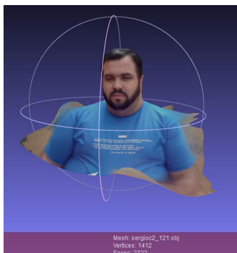
Figura 40 – Objeto reconstruído com os frames selecionados pelo protótipo de um vídeo.
