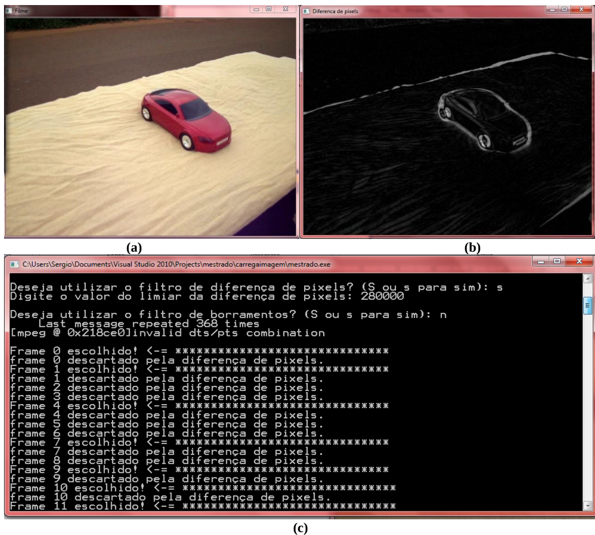
Figura 23 – Filtro de descarte por diferença de pixels em execução.
